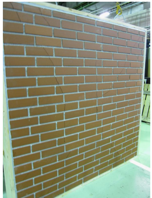
Valokuva 8. Tiilielementin lopullinen murtuma"envelope"-tyyppisesti.
