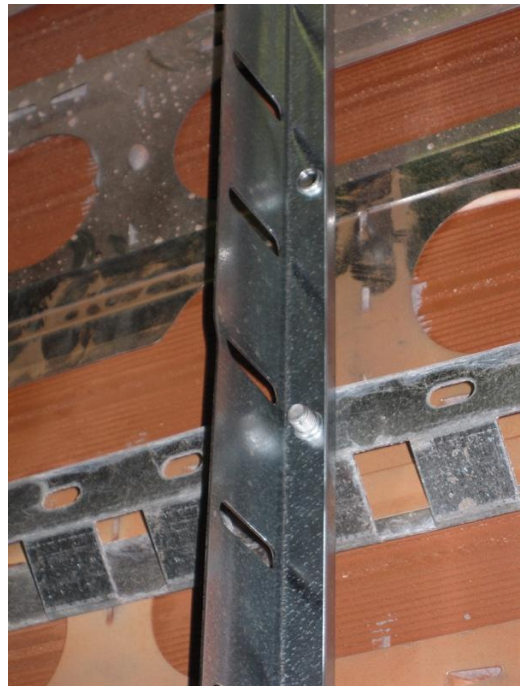
Valokuva 4. Murtuminen alkoi pystypystykiskon uuman lommahtamisena.
