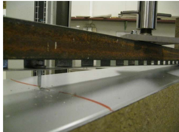
Kuva 6. Ruuvien murtokuorma saavutettu.
