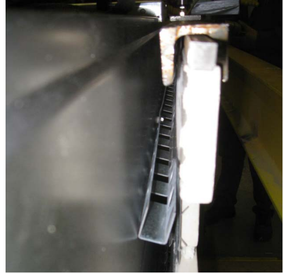
Kuva 1. Pystysuuntainen kuormitusjärjestely 1). Kuva 2. Kuormana omapaino + 120 kg.
