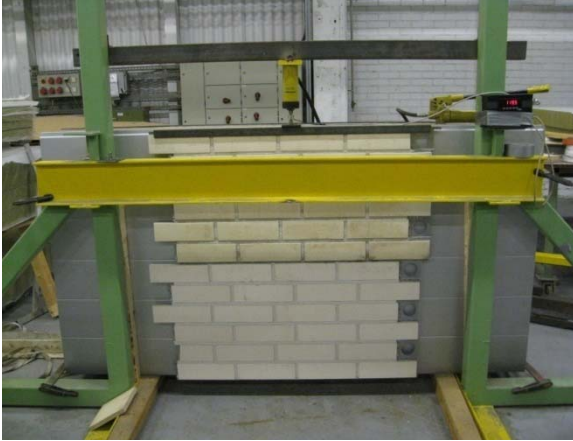
Kuva 1. Pystysuuntainen kuormitusjärjestely 1). Kuva 2. Kuormana omapaino + 120 kg.
