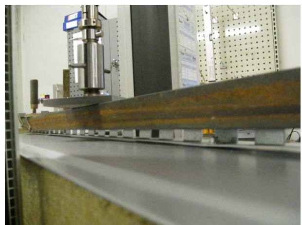
Kuva 8. 10 x vetokuormitus, SL2 -ruuvi
